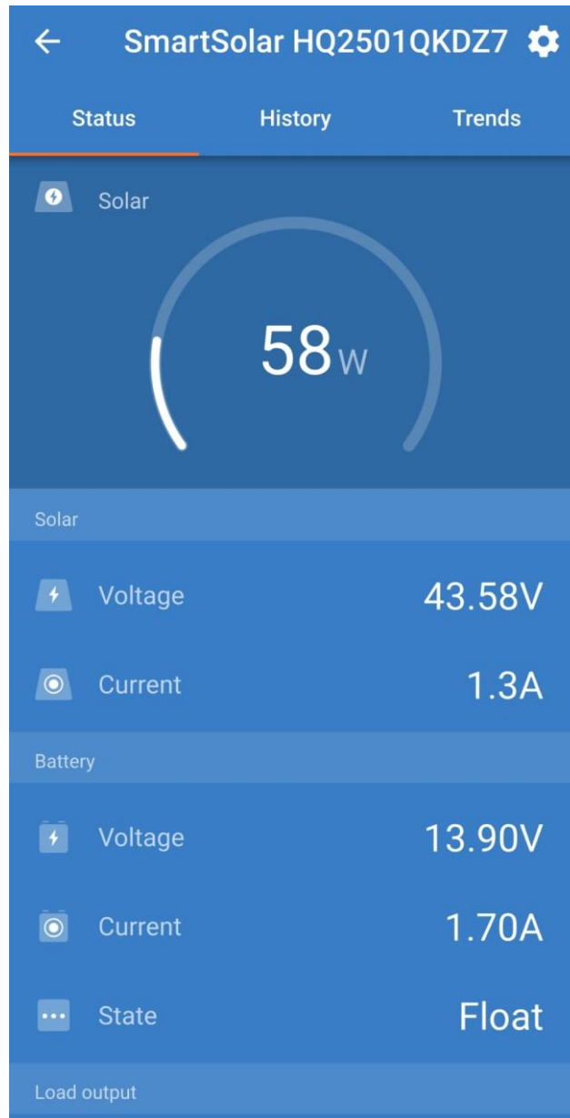
KUVA 12 AURINKOSÄHKÖJÄRJESTELMÄN SEURANTASOVELLUKSEN PERUSNÄKYMÄ, JOSTA VOIDAAN TARKASTELLA REAALIAIKAISTA TUOTANTOA, JÄNNITETTÄ, VIRTAA SEKÄ AKUN TILAA.
